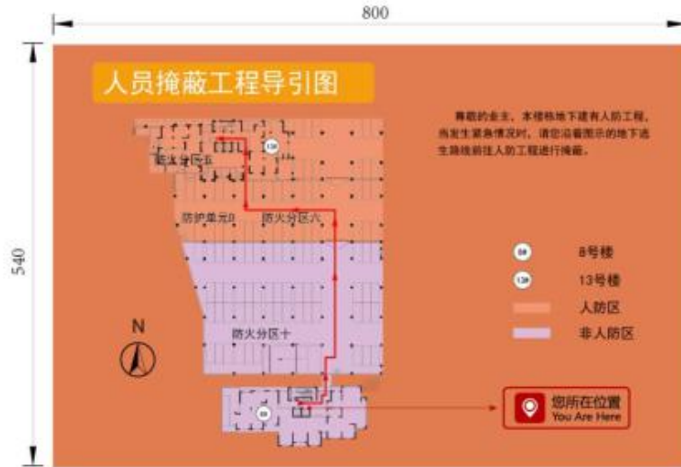
图 7 本楼栋地下能直通人防工程的导引指示牌样式及尺寸示例
