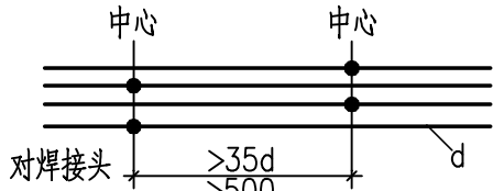
图3b. 焊接接头面积百分率50%
