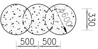
高压旋喷桩大样图 1:20
