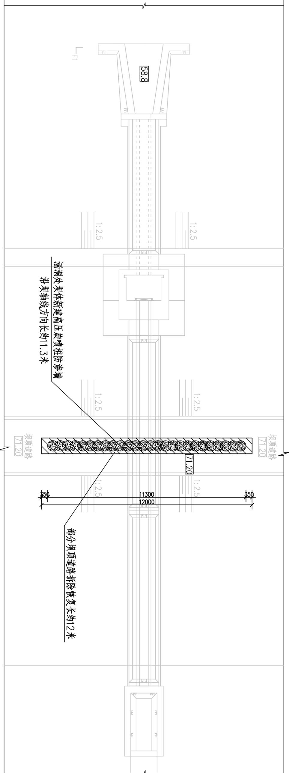
涵洞A新建高压旋喷桩防渗墙平面图 1:100
